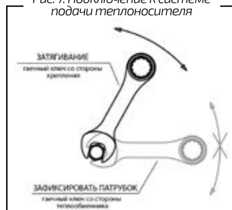
Рис. 7. Подключение к системе подачи теплоносителя
